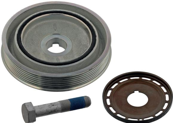
Prikazana remenica radilice pogona V kaiša služi pogonu pomoćnih uređaja. Sastoji se od metalnih i gumenih komponenti. Tokom vremena gumene komponente mogu oslabiti i može doći do njihovog pucanja, što dovodi do smanjenog ublažavanja vibracija čime se povećavaju vibracije i zvečanje motora prilikom promene opterećenja.
