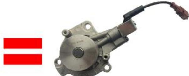
**Upozorenje!** Ako aktuator spojen na SKF mehaničku pumpu vode VKPC 81178 nije ispravno postavljen, na instrument tabli automobila može se pojaviti kod greške i svetlo upozorenja!
