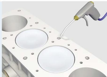
8. Očistite rupe sa navojem i uklonite svu nečistoću, ulje i vodu, npr. komprimovanim vazduhom.
