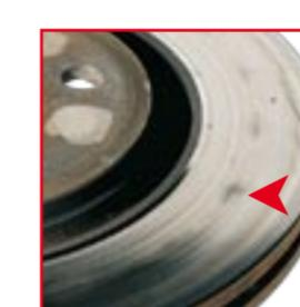
**SPOLJAŠNJI** Neravnometerno habanje kočnih površina. Plave tačke u središtu kočne površine. Moguća pojava napuklina
