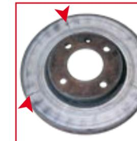
**SPOLJAŠNJI** Radijalne frakture/plave tačke koje se podudaraju sa okvirima za ventilaciju
