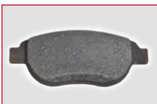
**IZGLED** Neravnomerno habanje na površini pločice
