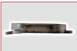
**IZGLED** Oštećena noseća pločica
