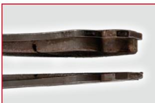
**IZGLED** Jedna ili više kočnih pločica u garnituri za osovinu biće preterano istrošena
