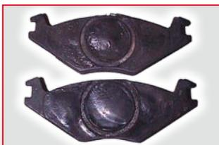
**IZGLED** Postojeći delovi za sprečavanje buke (gumeni pokrivač / podmetač) oštećeni klipom
