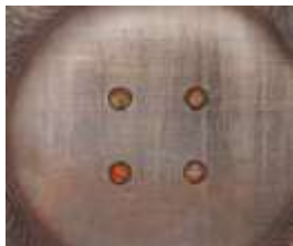
Zaprljana mlaznica injektora pre čišćenja
