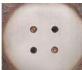
Mlaznica injektora posle čišćenja: nisu uklonjene sve naslage
