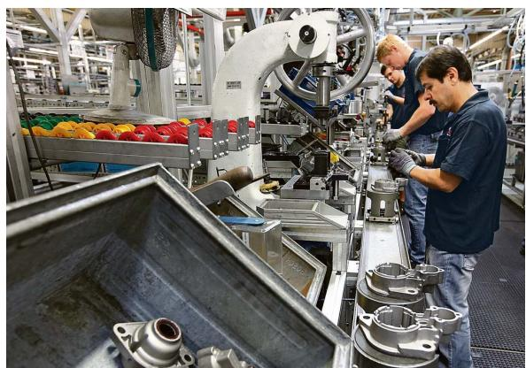
*Konačan komplet: različiti pojedinačni delovi se ponovo sklapaju zajedno kako bi se napravio ponovo novi proizvod na BPS traci.*
