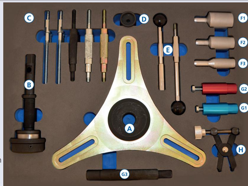
**Blue Print alat za samopodesivu spojku(SAC) predstavlja ključan komad opreme za osiguravanje pravilne ugradnje samopodešavajućeg tipa spojke. Djelovanje kontra sila na samopodesivu spojku tijekom ugradnje može dovesti do slučajnog rotiranja prstena za podešavanje, što dovodi do nepravilnog podešavanja spojke.**
