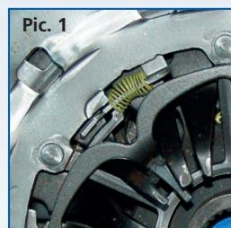
Samopodesive spojke može se identificirati pomoću samopodešavajućeg mehanizma koji se vidi na poklopцу spojke (vidi sliku 1).
