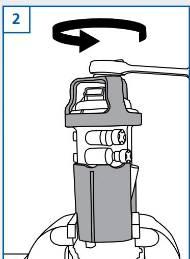
Korišćenjem ó"drive ratchet (zaporni mehanizam/otkidač) jednostavno olabavite prsten za pričvršćivanje okretanjem dela 'B' u smeru suprotnom kretanju kazaljki na satu.
