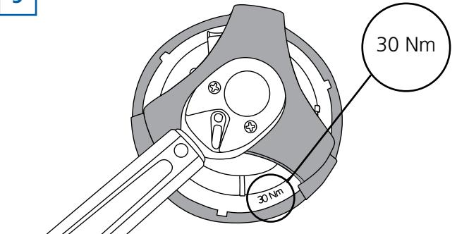
Zategnite prsten za pričvršćivanje na 30Nm, zatim namestite ponovo kućište u vozilo i ponovo konektujte sve cevi za gorivo i električne konektore. Startujte motor i proverite da li ima curenja.
