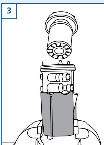
Izvucite gornji deo kućišta filtera i zamenite element filtera za gorivo (ADK82327) pazeći pritom da ne dodirnete papir filtera na novom elementu.
