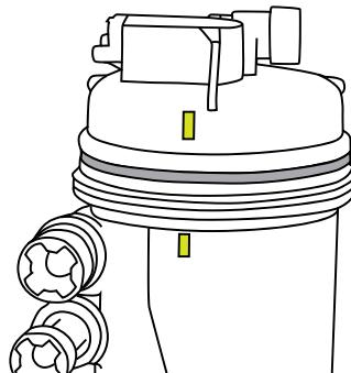
Zamenite gumenu zaptivku između dva dela kućišta sa onom koju ste dobili sa novim filterom. Namestite ponovo gornji deo na kućište tako što ćete poravnati žute/zelene markere.
