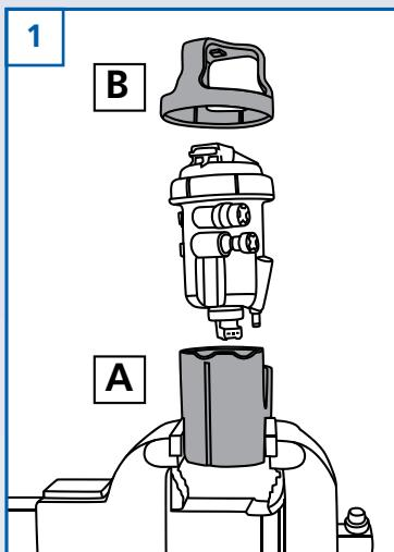
Stegnite deo 'A' u mengele. Izvadite kućište filtera za gorivo iz vozila, pazeći pritom da skinete sve cevi i električne konektore. Stavite kućište filtera u deo 'A' i smestite deo 'B' na gornji deo kućišta, tako što ćete poravnati šest ureza alata sa prstenom za pričvršćivanje kućišta filtera.
