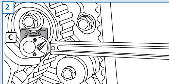
Adapter ležaja zatezača omogućava primenu obrtnog momenta u skladu sa uputstvima proizvođača koji može da varira između 2 i 5 Nm zavisno od modela. Dva osigurača na adapteru podešavaju se prema dva otvora na ležaju zatezača, a kvadratni otvor na adapteru omogućava korišćenje moment ključa malog obrtnog momenta (**ADG05515**).
