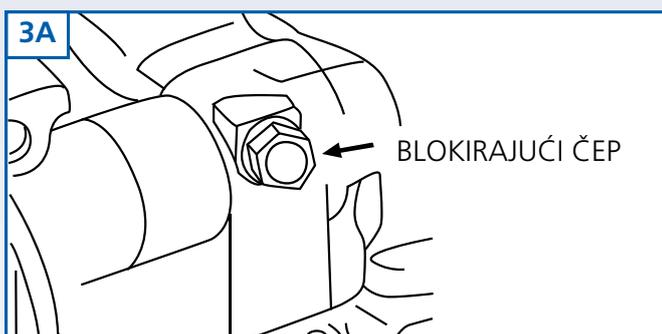
8mm osigurač se koristi na vozilima opremljenim sa uravnotežavajućim vratilom za blokiranje vratila. Važno: nije primenljivo na svim modelima. Ovo se radi skidanjem čepa iz prednje leve strane bloka motora i ubacivanjem osigurača do kraja, kao što je prethodno prikazano.
