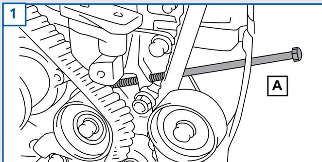
Dugački vijak zatezač koristi se za primenu dovoljnog pritiska na automatski zatezač kako bi se omogućilo skidanje potpornog osigurača hidrauličkog klipa zatezača bez rizika od oštećivanja delova sistema zupčanika razvoda.
