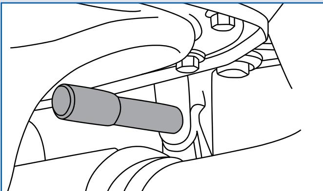
Osigurač 'A' se koristi za blokiranje radilice lociranjem u zadnjem delu zamajca, čime se omogućava da se zavrtanjem radilice olabavi/ponovo zategne.
