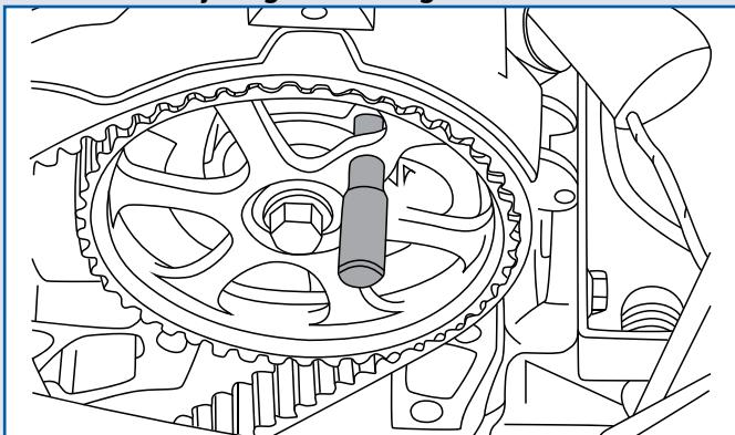
Osigurač 'B' se koristi za lociranje pogonskog ozubljenog točka bregaste osovine i da se osigura da se on ne pomera tokom skidanja i montiranja pogonskog kaiša.
