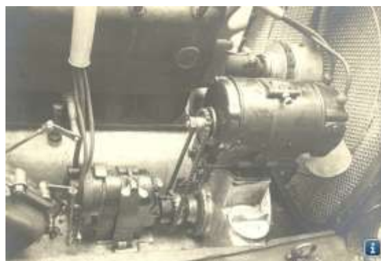
Bosch Generator, instaliran u Protos putnička vozila, 1913.
