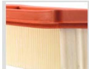
Loša obrada, zaptivni materijal niskog kvaliteta
